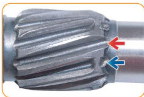
Em todo motor de partida que possui o **sistema stop spline**, o batente que limita o avanço do impulsor está no eixo induzido ou eixo da planetária. Esse sistema consiste em uma estria **passante** (seta vermelha) e outra **bloqueada** (seta azul).
