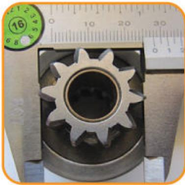
Alinhe os **dentes na horizontal** (conforme setas vermelhas) e **apoie os dentes superiores na régua do paquímetro** como indicado em azul. Pronto, agora temos exatamente o diâmetro externo dos dentes.
