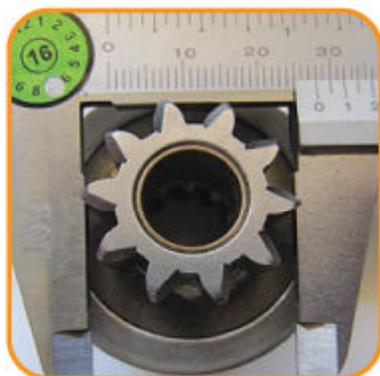
Cuadre los **dientes en la horizontal** conforme flechas rojas y **apoye los dientes superiores en la regla del paquímetro** como indicación en azul. De este modo tendremos exactamente el diámetro externo de los dientes.
