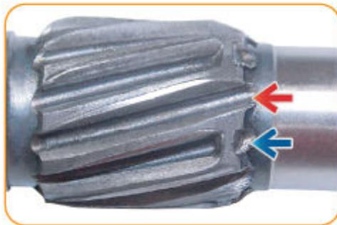
En todo motor de partida que posee el sistema **stop spline**, el batente que limita el avance del impulsor está en el eje inducido o eje de la planetaria. Ese sistema consiste en una estría **pasante** y otra **bloqueada**.
